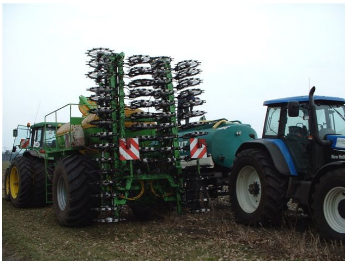
GFI 12 beim Befüllen mit Flüssigdünger auf dem Feld
